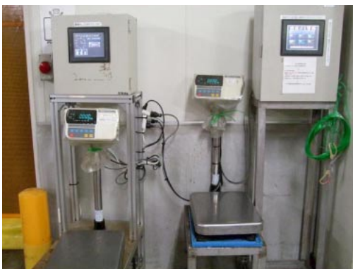
記録機能を持つ廃棄物計測用の秤 (埼玉工場事例)
