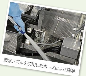
節水ノズルを使用したホースによる洗浄
