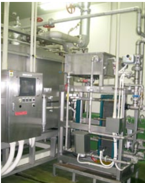
うどん茹釜の排水からの熱回収装置
